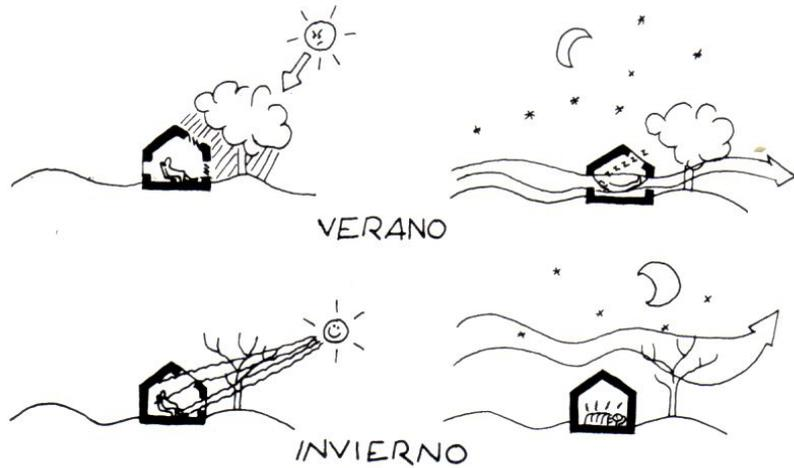
Los elementos climáticos principales, con respecto al bienestar humano y al diseño de edificios, son: la **RADIACIÓN SOLAR**, **TEMPERATURA**, **HUMEDAD**, **VIENTO**, **PRECIPITACIONES** Y **FACTORES ESPECIALES** COMO **MOVIMIENTOS SISMICOS**, **TORMENTAS DE POLVO**, etc.
